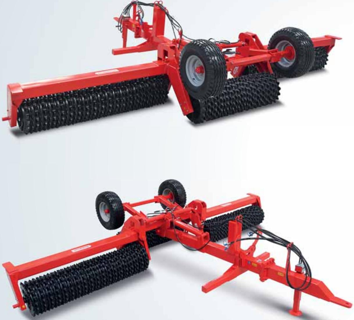
La tâche principale des rouleaux est de presser le sol. Ils servent à broyer et émietter les mottes infrangibles par les outils de travail du sol et à niveler la surface du champ. Les rouleaux peuvent être insérés dans le champ avant et après le semis. En l'insérant avant le semis, ils écrasent les mottes du champ cultivé, pressent le sol et assurent un équilibre entre les creux d'air, régulent le rapport eau-air du sol et préparent un bon lit de semence.
