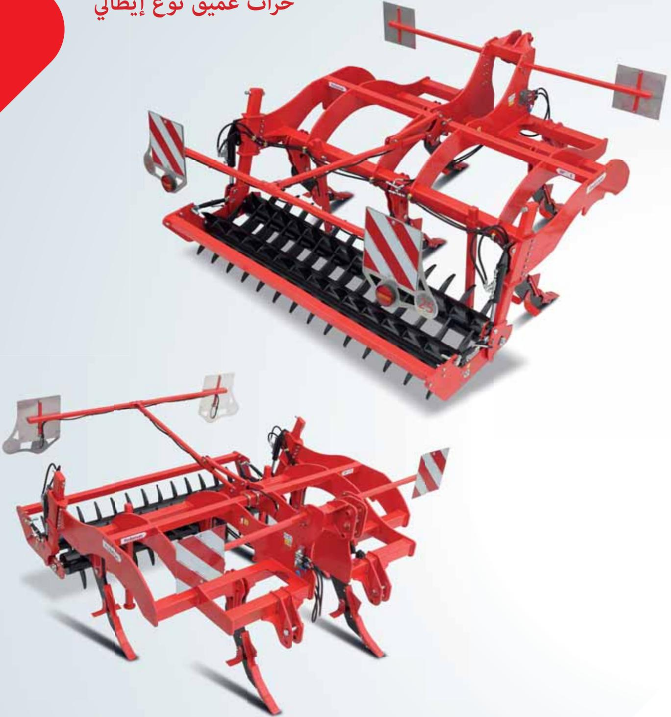
En raison de la structure de ses pattes, la sous-soleuse de type Italie est une machine suspendue qui cultive le sol sans laisser de terre brute entre les pattes, cassant le substrat de charrue et sans monter au-dessus la terre improductive de la couche inférieure du sol.
