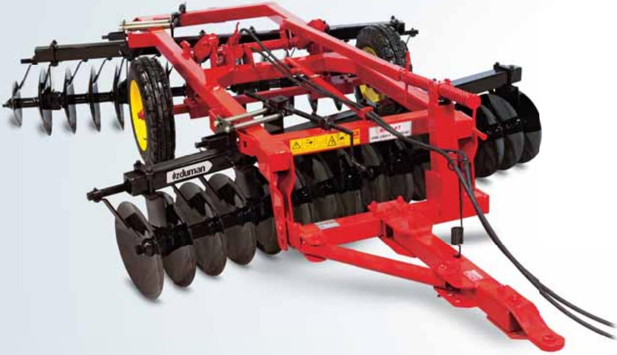
Le pulvérisateur à disques tractable à roues relevables est un engin de travail du sol qui permet de préparer le lit de semence en cassant les mottes et en mélangeant la terre après la charrue.
