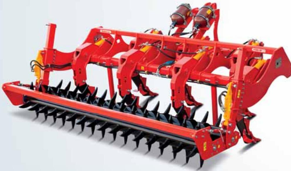
La sous-soleuse de type italien avec accumulateur hydraulique; ce modèle assure un fonctionnement sûr sur les sols pierreux grâce aux hydropneumatiques ajoutés aux pattes pour plus de sécurité. En raison de la structure de ses pattes, c'est une machine à suspension qui cultive le sol sans laisser de terre brute entre les pattes, cassant le substrat de charrue et sans monter au-dessus la terre improductive de la couche inférieure du sol.
