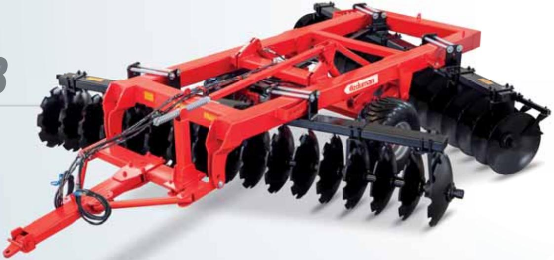
Les pulvérisateurs offset de type tractable avec levage hydraulique sont des machines tractables utilisées pour couper et broyer les résidus végétaux (maïs, tournesol, blé, etc.) et les mauvaises herbes après la récolte et pour casser la couche de crème.
