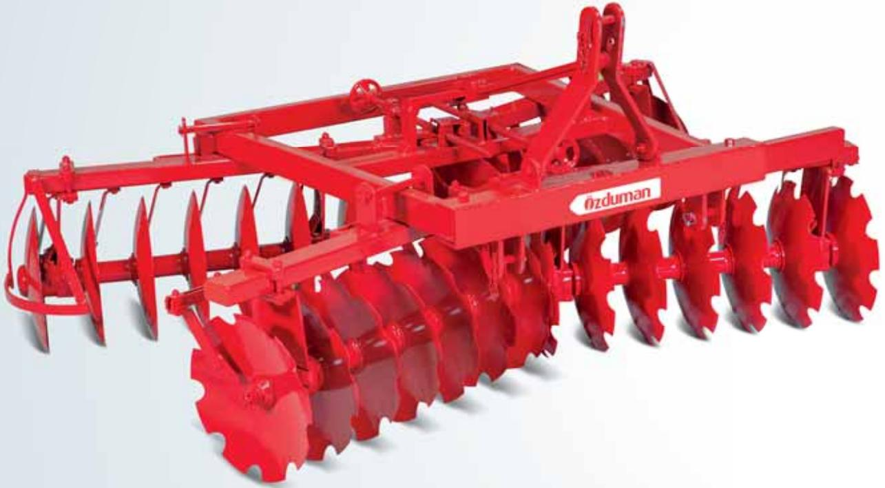
Le pulvérisateur à disques tandem suspendue de type X est utilisé dans la préparation du lit de semence et du lit de semis dans l'horticulture. Il brise les tiges des plantes et les résidus laissés dans le champ après la récolte et les mélange au sol. Après avoir utilisé des outils tels que charrue, chisel et cultivateur, il brise les mottes formées dans le champ et émiette le sol. Il peut également être utilisé facilement dans les zones arborées grâce à ses trois suspentes coulissantes.
