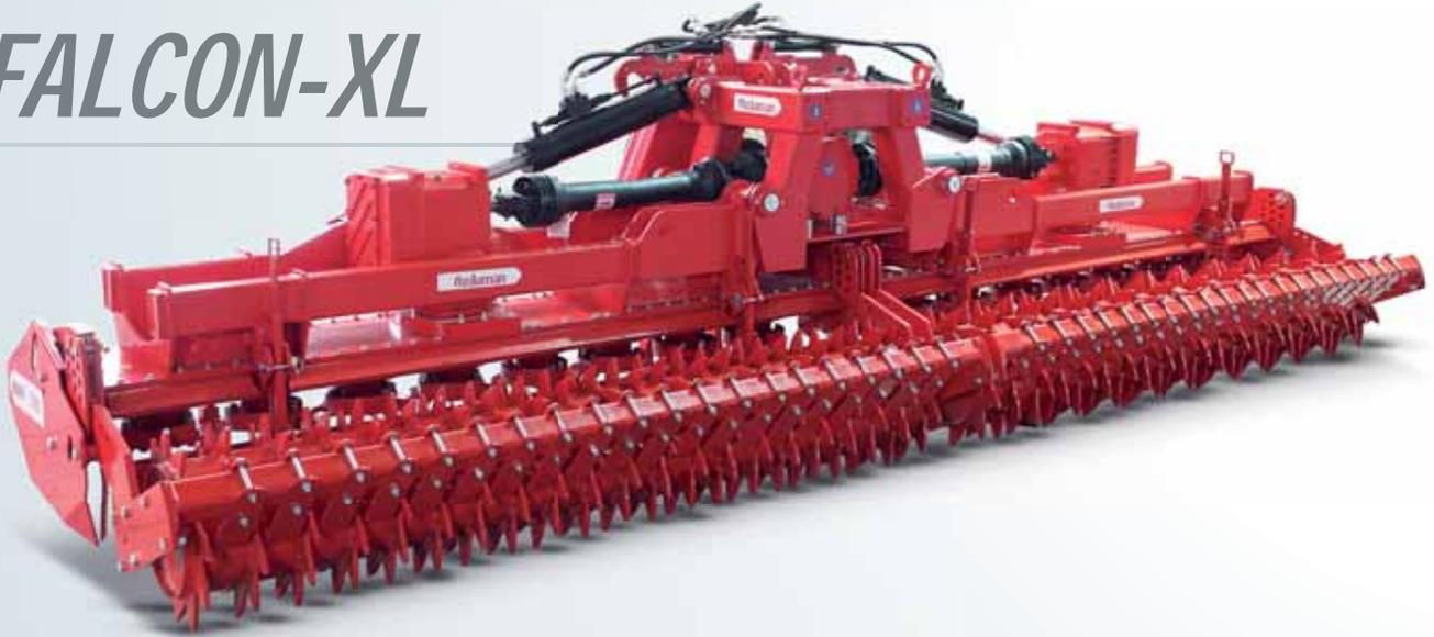
Le rotoculteur vertical mécanique est constitué de pales rotatives qui tournent au moyen d'engrenages parallèles à la surface de la terre et verticaux par rapport à la direction du mouvement qu'il puise du cardan du tracteur. C'est un équipement de travail du sol et de préparation des lits de semence facile à utiliser.
