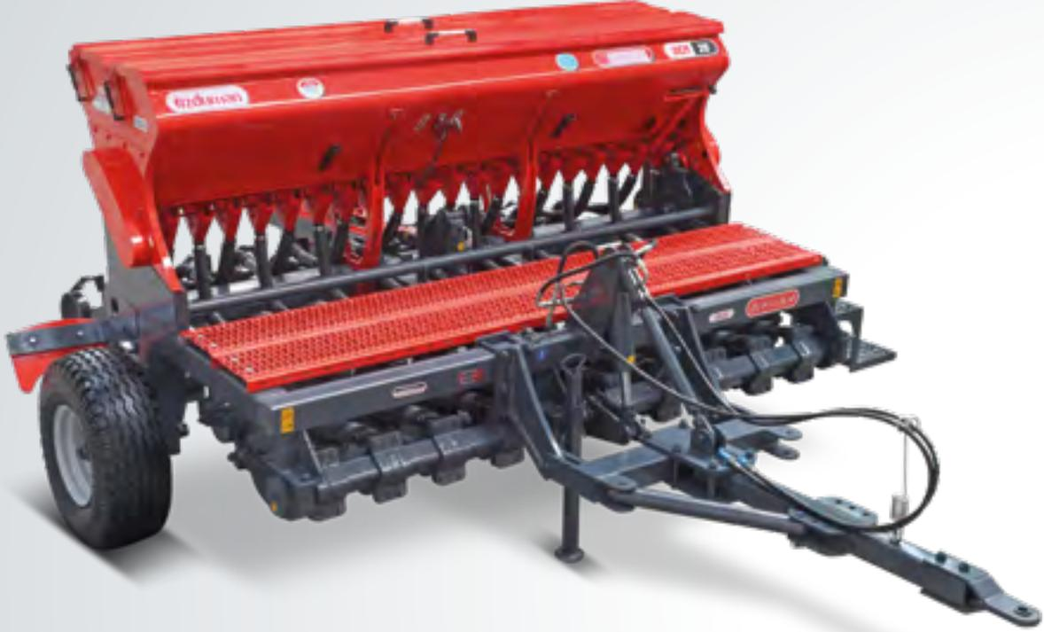
Il s'agit d'un semoir de type tractable, facile à utiliser qui laisse les grains de céréales, de légumineuses et de fourragères et l'engrais à l'aide du système de grade en quantité et profondeur souhaitées vers le lit de semence ouvert sans interruption par les disques grâce aux rouleaux ondulés hélicoïdaux sur les terres traités, semi-traités ou non traités avec le semoir à semer directement sur le chaume.
